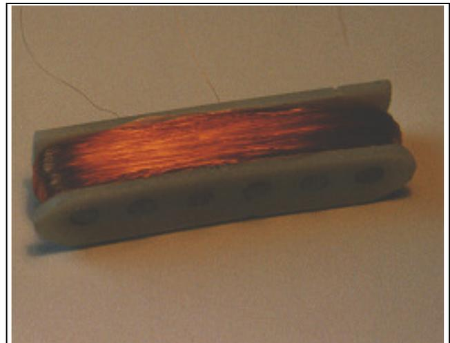
Bild 3.2.3: Wicklung mit Vorspannung (3500 Wicklungen)
